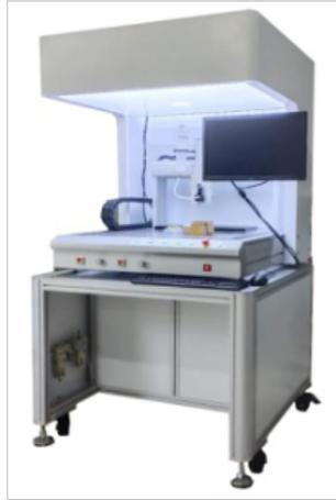
蜡模镶钻机日常保养：1、更换胶种，需清洗管路。此时先关闭进料阀，打开排料阀，将胶桶剩余胶料排出后，关闭排料阀打开进料阀将清洗溶剂倒入储胶桶内，开机机体，按平时操作方式将溶剂压出冲洗。2、气压进气不正常及发现有水气，请将调压过滤器内之水气排除或检查气压源有无异样即可。蜡模镶钻机在胶水大量使用前，请先小量试用，掌握产品的使用技巧，以免差错，当测试没问题时，再用双液滴胶机或双液灌胶机进行大批量的生产；抽真空系统对胶水进行抽真空除泡处理，以排除搅拌过程中产生的气泡，或静置10-20分钟再使用，以使混合时产生的气泡及时排除，混合在一起的胶量越多。
